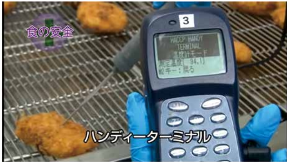
画14 中心温度は筆記用具を使用せず記録が自動的に管理される
